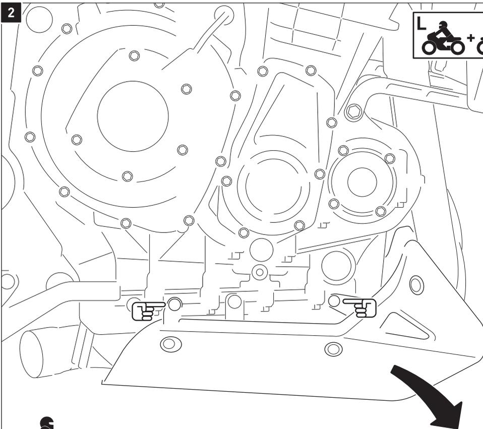
Lösen Sie beidseitig die markierten Schrauben und entfernen Sie den originalen Motorschutz vom Fahrzeug.
