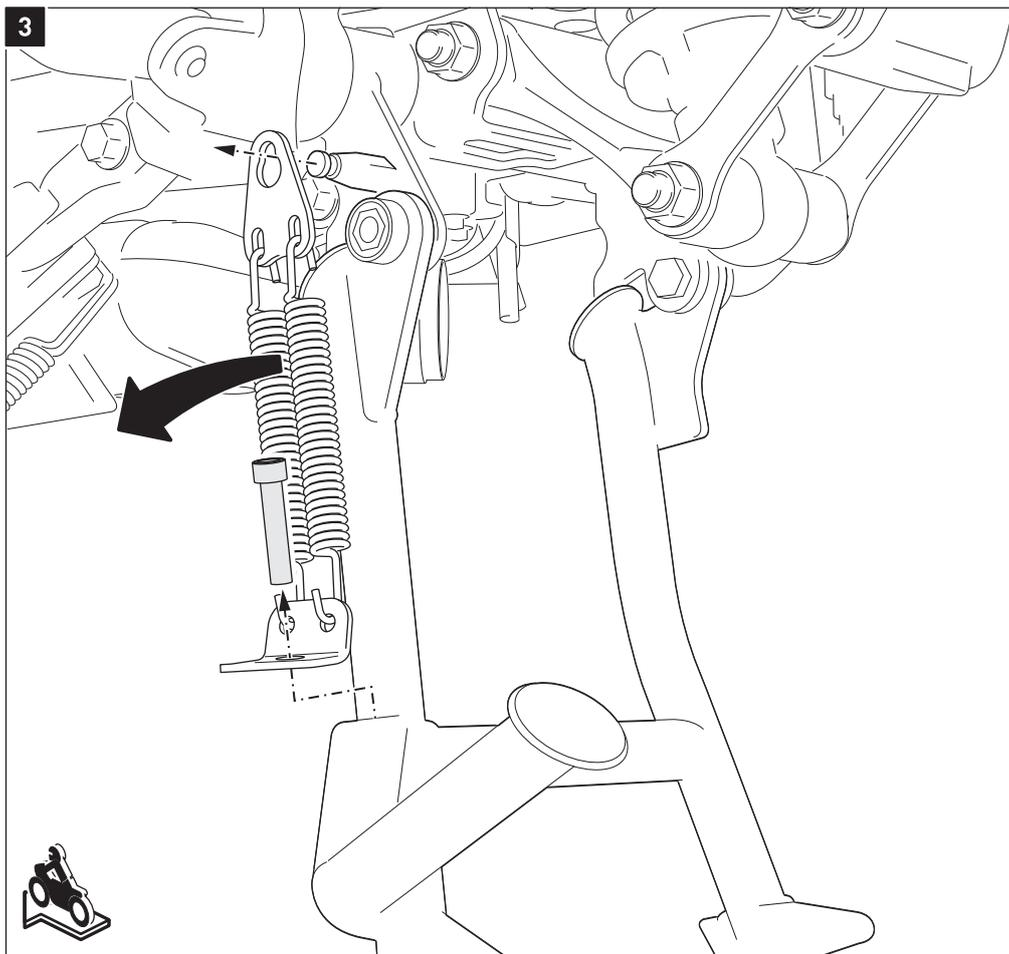
Lösen Sie die markierte Schraube des Hauptständer-Federsatzes und entfernen Sie diesen vom Fahrzeug.
