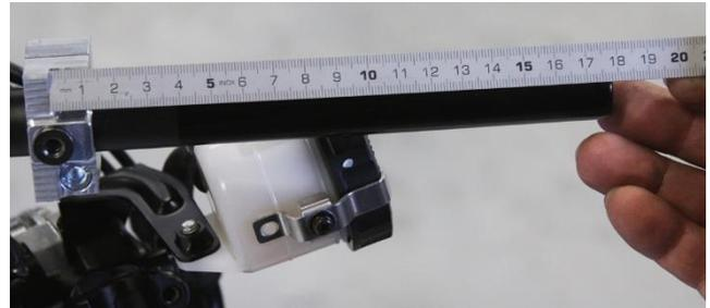
Bestimmen Sie die Position der Bohrungen in Umfangsrichtung entsprechend der später gewünschten oder empfohlenen Stellung der Bedienelemente.
